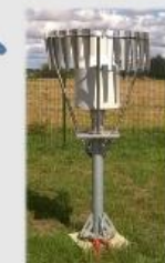
Atmosfēras nokrišņu sensors (60 mērījumi minūtē)
