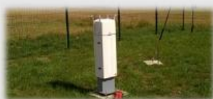
Mākoņu augstuma sensors (30 mērījumi minūtē)
