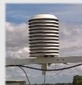
Gaisa mitruma un temperatūras sensors (10 mērījumi minūtē)
