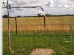
Sniega segas biezuma sensors (10 mērījumi minūtē)
